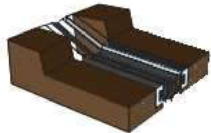
Hình 5 Khe tại vị trí bó vữa và đi vào phần lan can.
