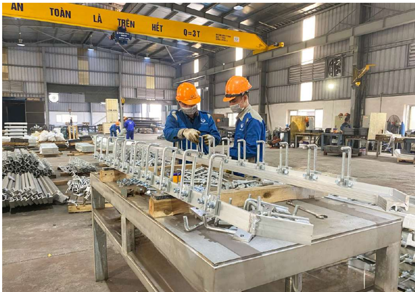
Sản xuất khe co giãn hợp kim nhôm VHAL tại Nhà máy Vĩnh Hưng IP
